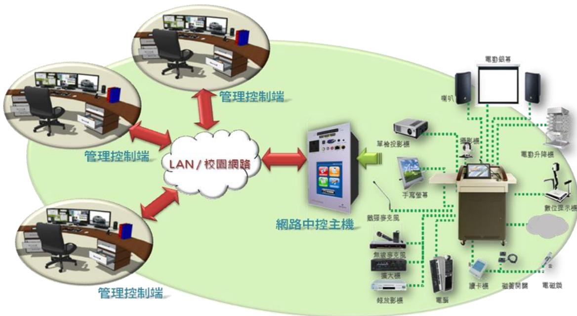
電化教室採用 Cat.5 網路線作為資料通信傳輸，取代了傳統的同軸電纜傳輸，真正實現了數位化網路傳輸，提高了音、視頻傳輸通信的品質，最高支援 1600\*1200 解析度。作為新一代網路多媒體教學控制系統，在顯示效果和作業系統的相容性方面可以兼容 Windows 7，在應用上已經成功安裝至多所學校，受到了廣大使用者的好評，RMCS 將為您建構最強大的新一代多媒體網路教室。
