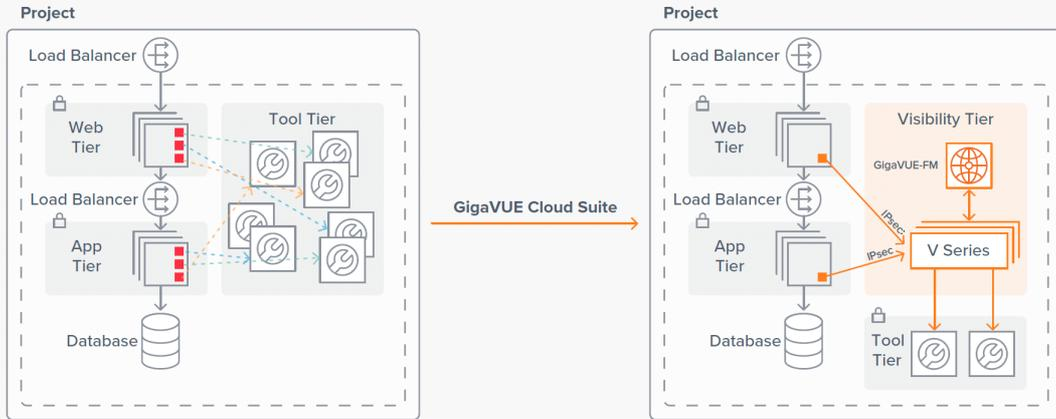
基礎架構即服務 (IaaS) 的快速發展帶來了規模經濟，彈性和靈活性的即時優勢。尋求現代化 IT 基礎架構的組織的敏捷性。這種方法的明顯挑戰包括無法訪問所有流量以支持威脅檢測和響應以及這些環境中的應用程序和網絡性能。當前的安全和監視工具在諸如 OpenStack 之類的私有云中進行操作經常缺乏對運動中的這些數據的完全訪問。解決此難題的一種方法是採用下圖所示的內容。
