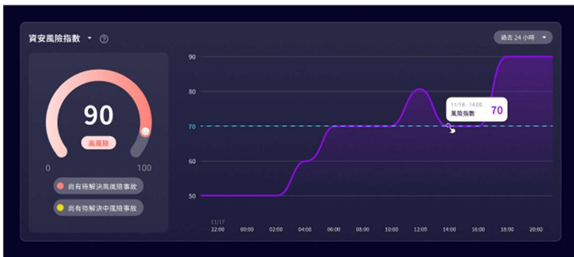
「**數據監控模組**」提供**視覺化儀表板**分析資安情勢的重要資訊，其中包括資安風險指數與趨勢、重要資安事故發生情形、重點監控目標等，方便使用者短時間內察覺系統資安弱點，並根據使用者設定在資安事故發生時立即告警，提醒使用者採取防護措施。
