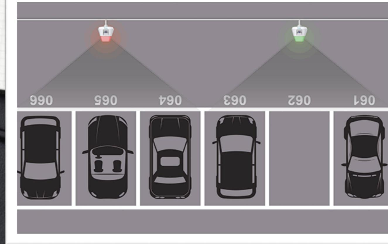
透過系統偵測控制在席顯示燈號、即時更新區域停車導引字幕屏，客戶並可於智慧查詢機找到車輛停放車格，動態圖示導引客戶到車輛停放位置。讓使用者從進入停車場到離場，透過系統的輔助快速找到車位，提升客戶使用的便利服務體驗
