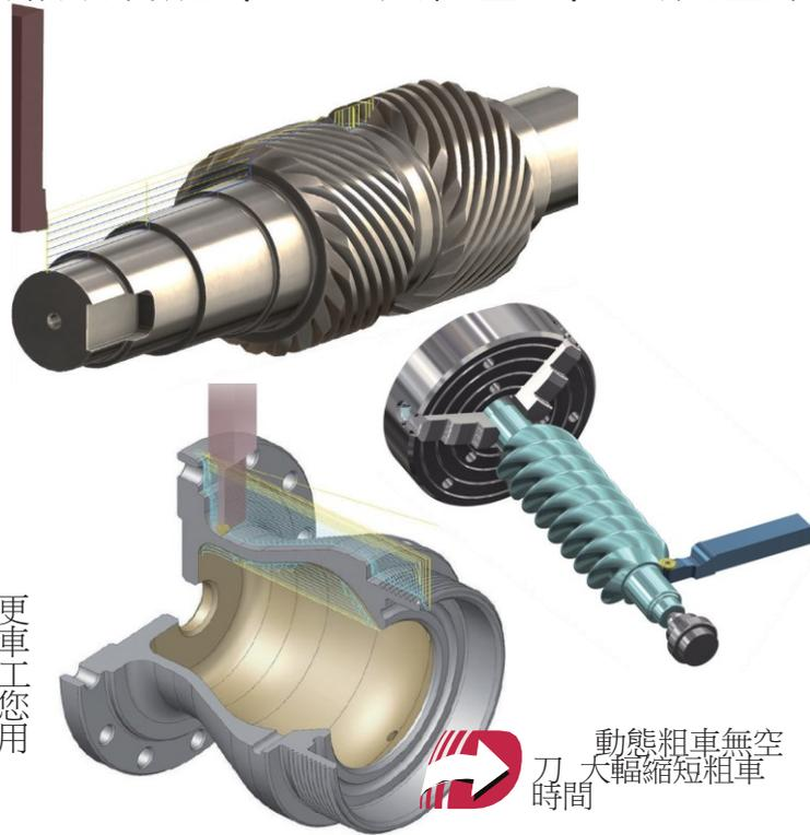
先進的高效車削工法策略，可以更快速更精確地車削零件。 Ex: 動態粗車、切入車削、輪廓粗車、Prime Turning 及自定螺紋工法策略。這些高階的工法應用，能夠讓您更有效的節省車削加工時間及降低使用刀具數與成本，進而提高生產率。
